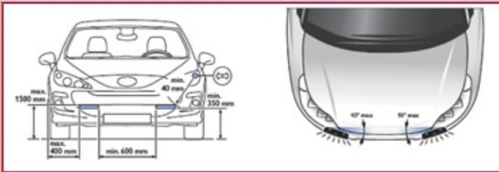
Veillez à positionner les feux de jour conformément au schéma ci-dessus. Afin d'épouser la silhouette du véhicule, les feux de jour ont été conçus pour assurer une inclinaison horizontale de 10° conformément à la réglementation.
